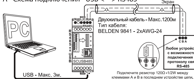
А - Схема подключения - USB &lt;--&gt; RS485
